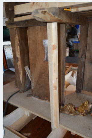
Fig. 30: Tábua de madeira com borne ligeiramente atacado por insetos xilófagos. DETALHE, Conservação e Restauro de Mobiliário ©
