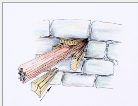
Fig. 33 a) - c): Sistemas de fixação de elementos do retábulo à parede. No retábulo da Sagrada Família, o sistema de entrega dos barrotes à parede seria o ilustrado ao centro. Os barrotes (assinalados na imagem da esquerda) seriam travados com cunhas de madeira. Na figura à direita está representado um outro sistema que frequentemente se encontra em altares com outro desenho e em que elementos estruturais eram pregados num taco de madeira introduzido na parede. Esses tacos de madeira eram frequentemente segmentos de ramos das árvores. DETALHE, Conservação e Restauro de Mobiliário ©
