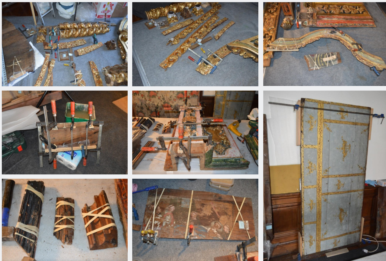
Fig. 25 a) - h): A colagem de fraturas e elementos soltos foi feita com pva. O sistema de aperto foi o adequado às várias situações. DETALHE, Conservação e Restauro de Mobiliário ©
