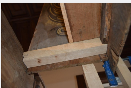
Fig. 43: Elementos de apoio da base do nicho. DETALHE, Conservação e Restauro de Mobiliário ©
