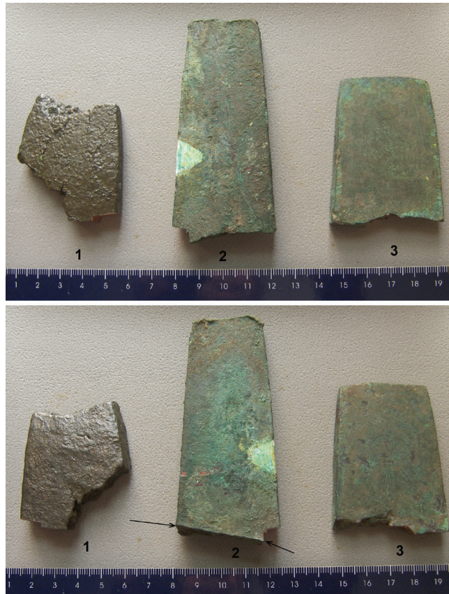
Fig. 3 – Machados-lingote: 1 - Três Moinhos (TM-1); 2 - Porto Mourão (PM-1); 3 - Porto Mourão (PM-2). Note-se a prega/rebarba de dobragem, assinalada por setas, no machado-lingote PM-1.
