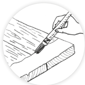
Aplicação de preparação num suporte de madeira.
